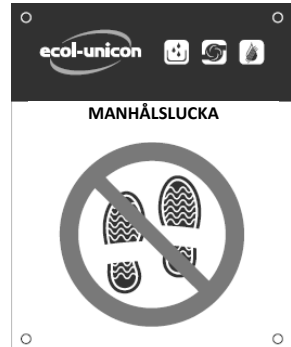
Fig. 47 Märkning av manhålsluckan
