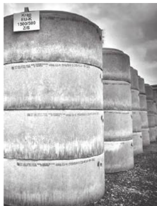
Fig. 13 Lagring av förtillverkade betongelement
